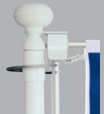
Drehhausleger 360° GfK-KAT-KAK Innenseilführung, Hisseil 2-teilig mit Entraller, Mastkopf drehbar gelagert
